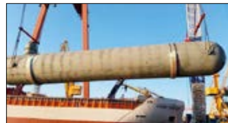
Verdens største CO 2 -tanker med en kapasitet på 1800 tonn nedkjølte CO 2 er plassert ombord. Tankstørrelsen tilsvarer 90 trailerlass. Her heises den om bord i Yara Gerda.
